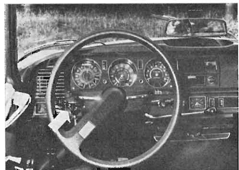
Grazie alle guide di luce « Crofon » i proprietari della Citroën « D » non devono faticare per trovare al buio la sede della chiavetta d'accensione.
